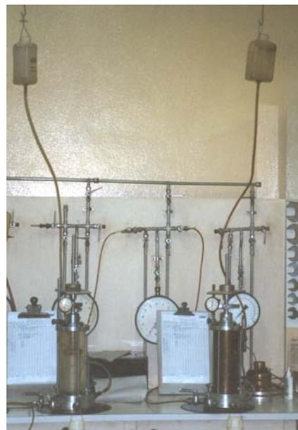
**Figura 27.** Saturação dos corpos talhados.
