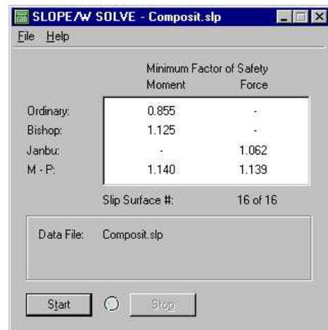
**Figura 39.** Determinação dos fatores de segurança de uma seção.
