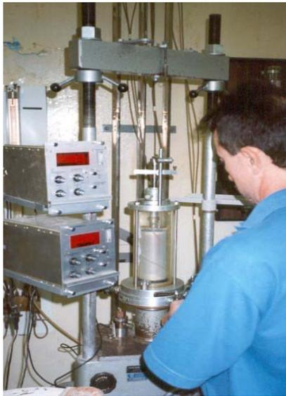
**Figura 28** Colocação da câmara na prensa.
