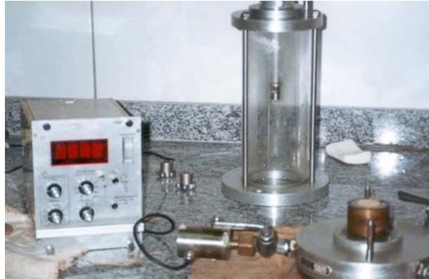
**Figura 25.** Câmara triaxial desmontada (notar o transdutor utilizado acoplado para verificação das pressões neutras).
