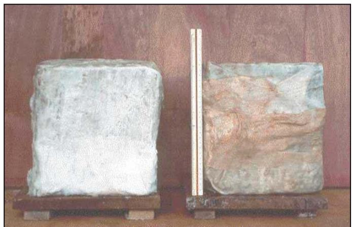
**Figura 24.** Bloco de amostra indeformada parafinada.
